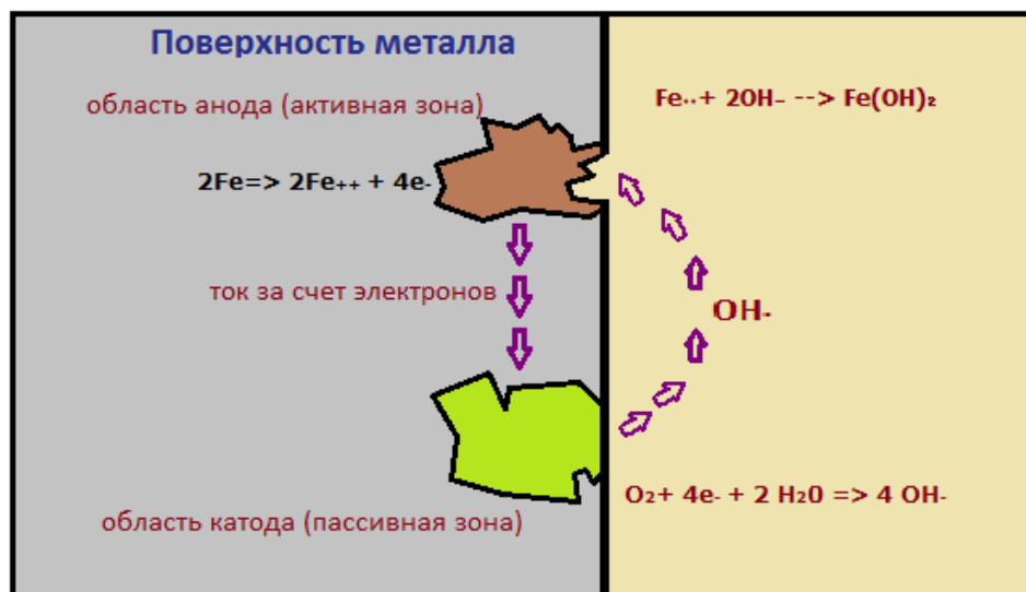
Рис. 1. Механизм гальванической коррозии на поверхности металла.
